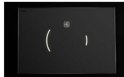
Nachtlicht-Funktion mit umgebungslicht-abhängiger Intensitätssteuerung
